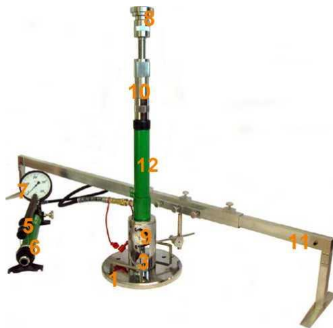
Rys. 1.2 Aparatura VSS z jednopunktowym pomiarem przemieszczenia płyty
