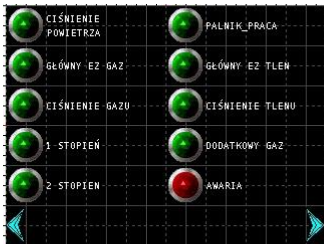
Rys.2 panel diagnostyczny z kontrolkami
