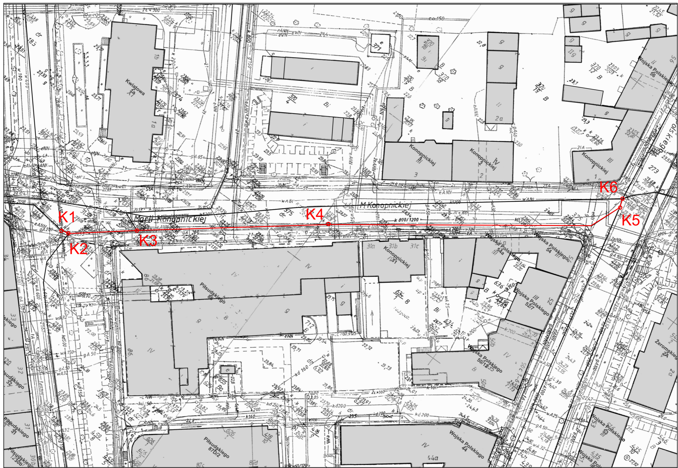
— K1-k6- sieć kanalizacyjna ogólnospławna do remontu DN 800/1200 (beton); L ~166m
