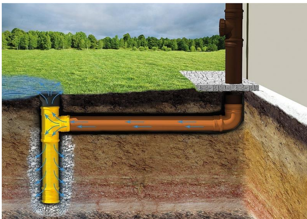
Rys. 1. Schemat montażu studzienek przelewowo-rozsączających.
