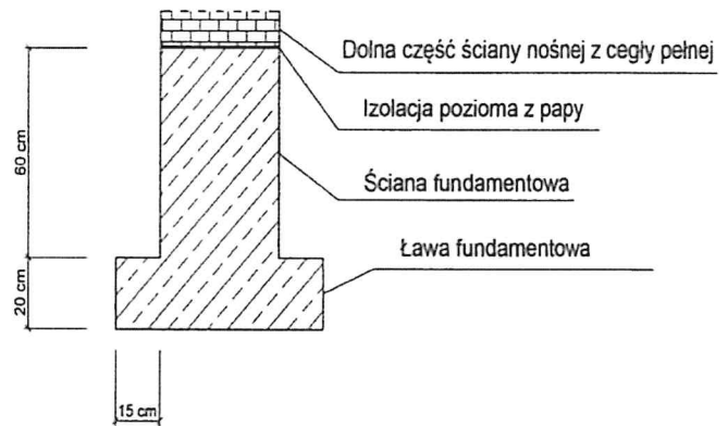
Rys. 2. Posadowienie budynku: a) widok odkrytki fundamentu b) rysunek poglądowy fundamentu.
