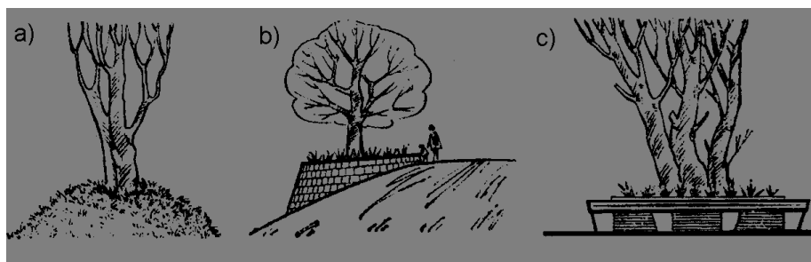
a) pozostawiony ścięty stożek z gruntu, ochraniający korzenie drzewa b) ścianka podporowa z kamienia wokół drzewa pozostawionego na skarpie c) ścianka oporowa dostosowana do odpoczynku podróżnych przez wykonanie ławki na jej górnej powierzchni
