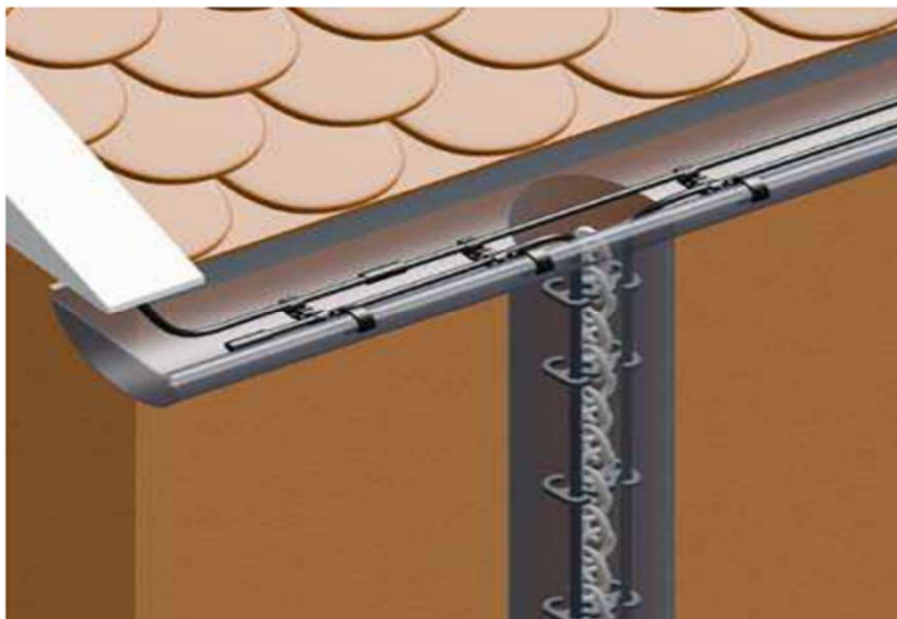
Rys. 1 sposób montażu przewodów w rynnie
