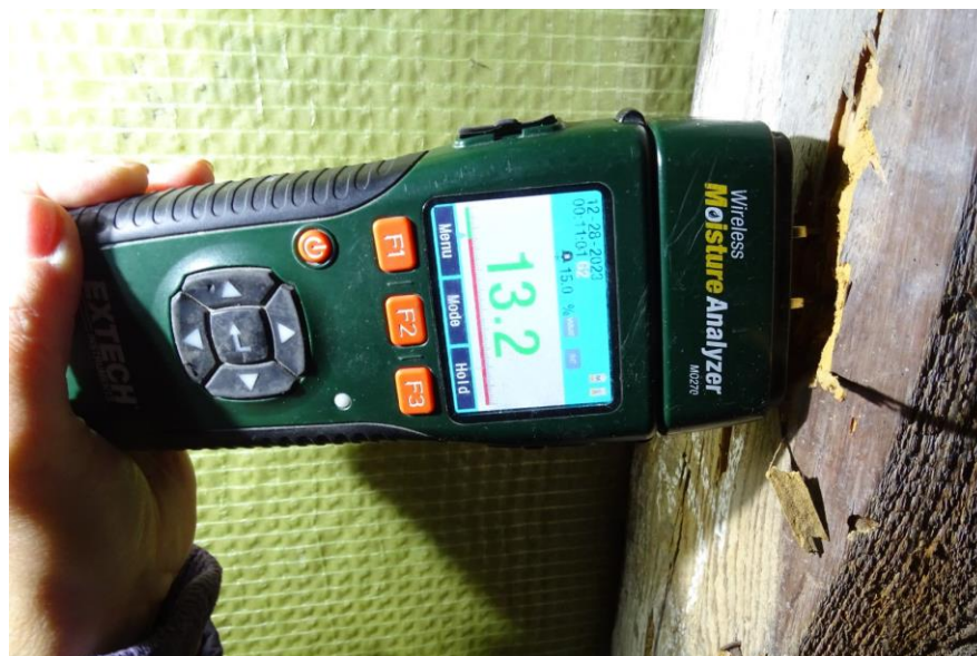
Fot. 63 Pomiar poziomu wilgotności na krokwi: 13,2%
