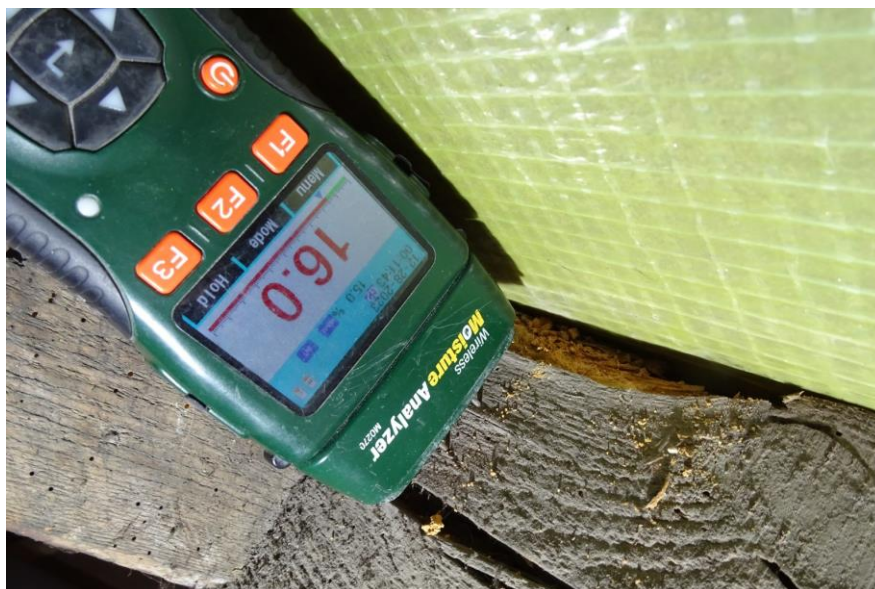
Fot. 65 j.w. na kolejnym elemencie drewnianym: 16%
