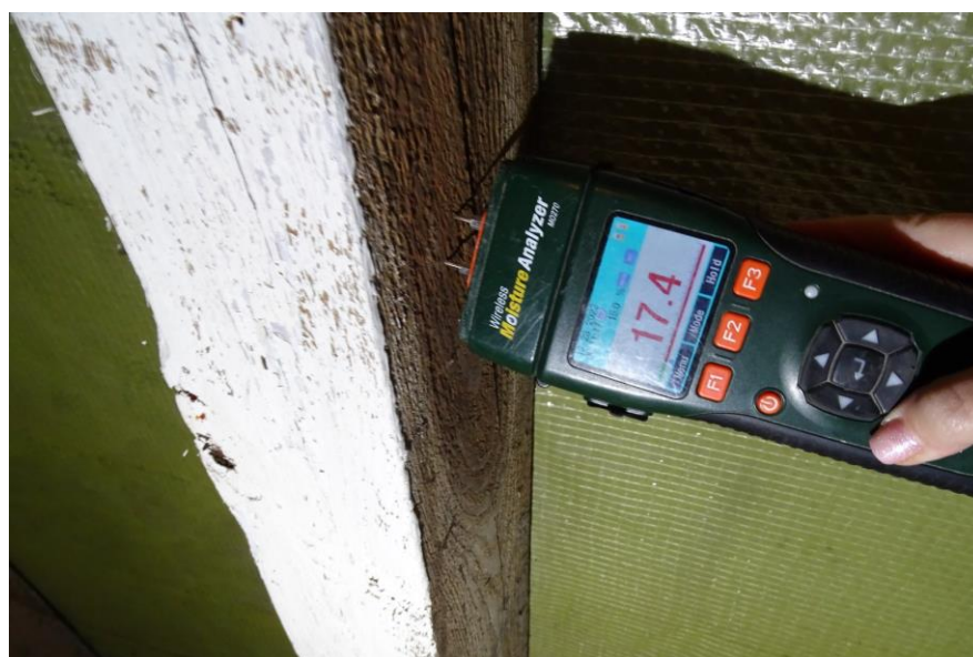
Fot. 64 j.w. na kolejnej krokwi: 17,4%
