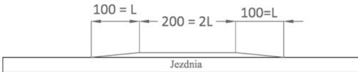
Rys. 1. Płytowy próg zwalniający – przekrój podłużny
