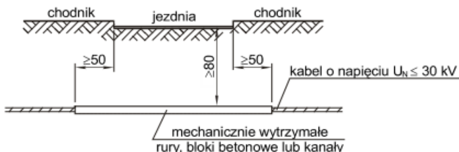
Układanie kabla pod jezdnią
