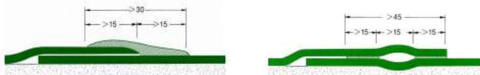
Rys. 2. Schemat połączeń geomembrany
