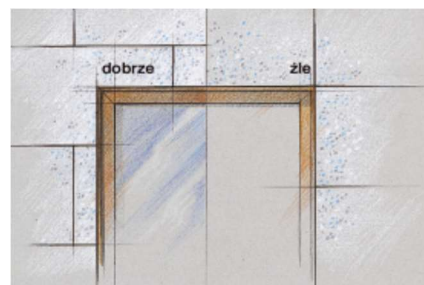
Rys. 17. Schemat układu płyt w pobliżu otworów
