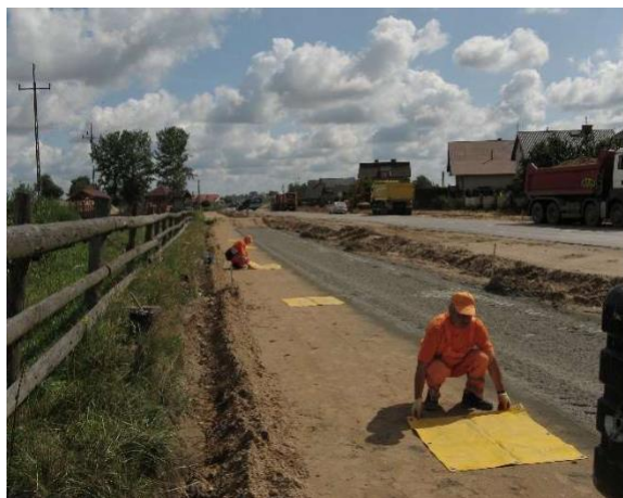
Rozmieszczenie tacek pomiarowych
