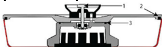
Rysunek 38: Rotor cytowirówki — widok z boku
