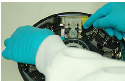
Rysunek 46: Usuwanie pozostałości płynu
