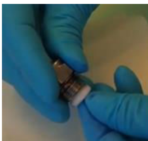
Rysunek 32: Ponowne zamontowywanie dyszy w aparacie
