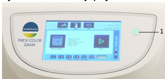
Rysunek 18: Lokalizacja przycisku Oczekiwanie/gotowość
