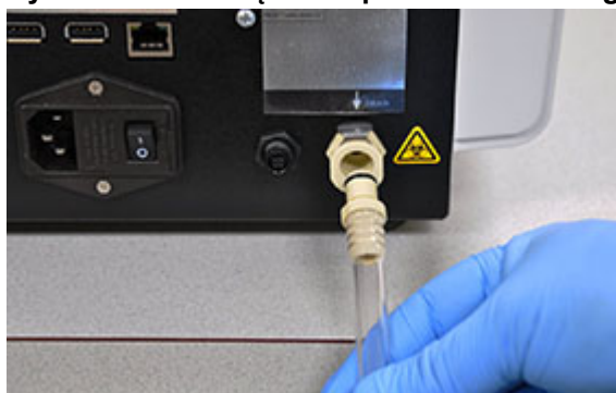
Rysunek 10: Podłączanie przewodu rurowego odpadów do aparatu
