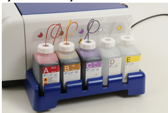
Rysunek 13: Umieszczenie butelek z odczynnikami
