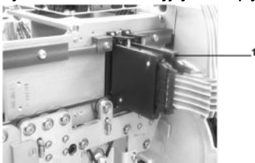
Rysunek 24: Transmitancyjny układ optyczny TX1 i TX3
