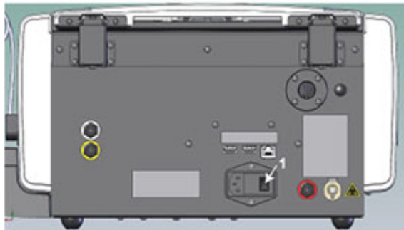
Rysunek 17: Lokalizacja głównego włącznika zasilania
