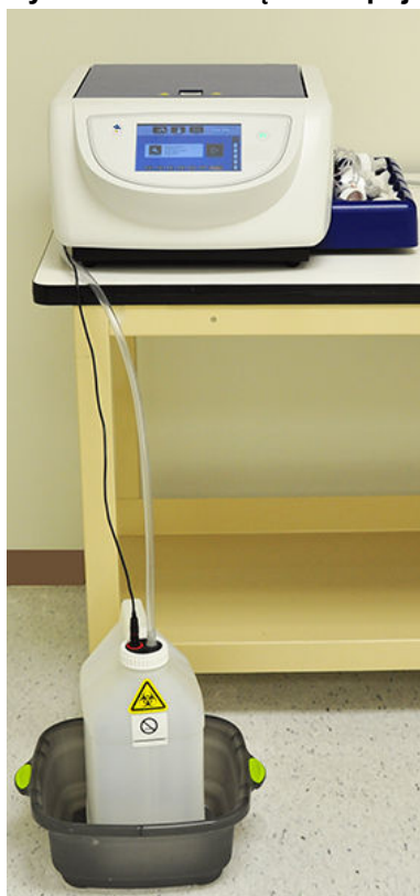
Rysunek 12: Podłączanie pojemnika na odpady
