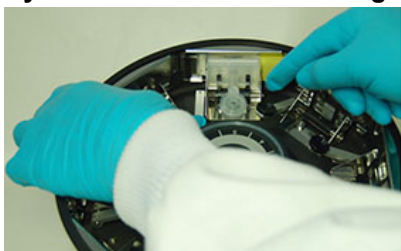
Rysunek 43: Zwalnianie dźwigni
