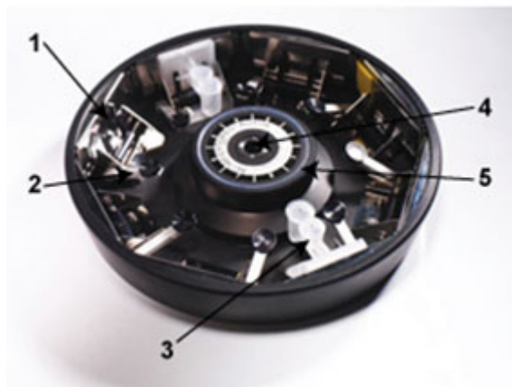
Rysunek 36: Rotor cytowirówki
