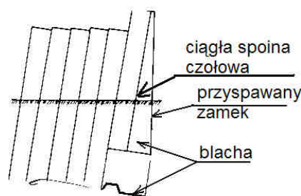
Rysunek 8. Pale specjalne wykorzystywane do zniwelowania pochylenia ścianki
