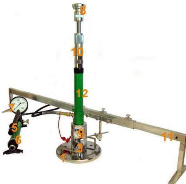
Rys. 1.2 Aparatura VSS z jednopunktowym pomiarem przemieszczenia płyty
