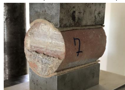
Rys. 1 Sposób badania wytrzymałości muru na ściskanie
