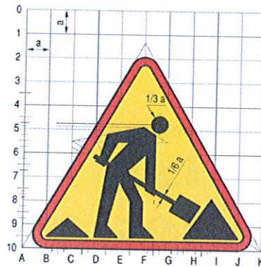
A-14 „Roboty na drodze”
