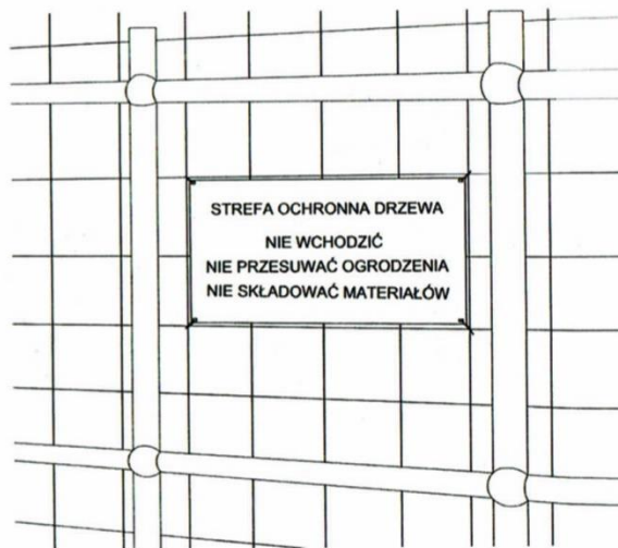
Rys. Przykład oznaczenia tablicą informacyjną strefy ochronnej drzewa. Rys. Świder, źródło: Suchocka M. 2016.
