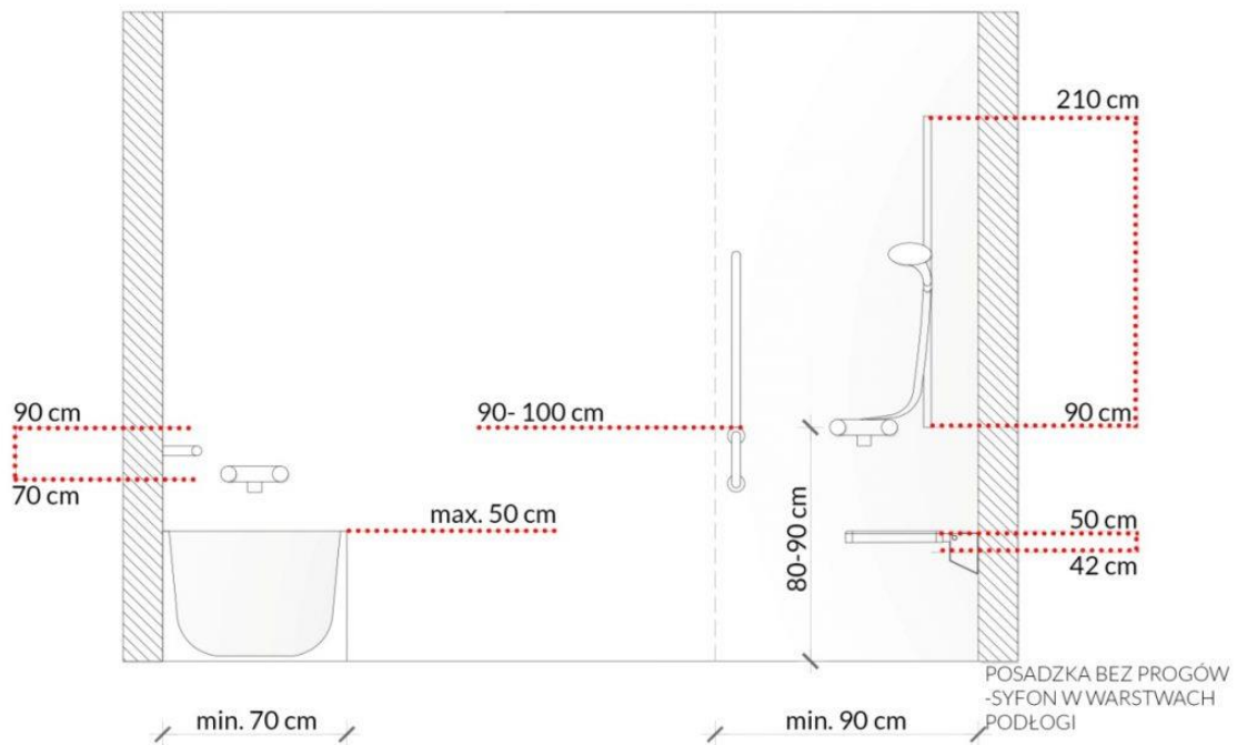
Rys. 100. Wymiary prysznicza, wanny oraz elementów towarzyszących dostępnych dla osób z niepełnosprawnościami [100]
