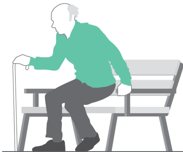
Rys. 126. Ławka z oparciem i podłokietnikami ułatwiającymi korzystanie z niej m.in. osobom starszym oraz z niepełnosprawnością ruchu [126]
