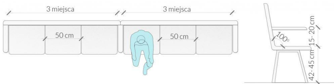
Rys. 42. Wytoczne i wymiary dotyczące ławek [42]
