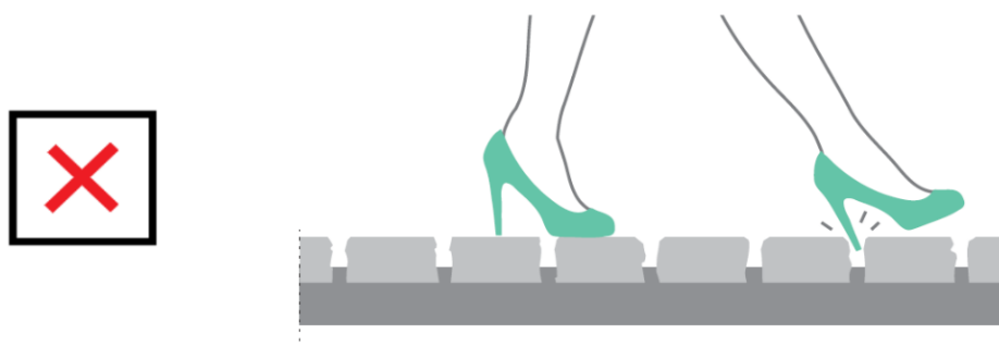
Rys. 128. Nawierzchnia o średnim stopniu równości [128]
