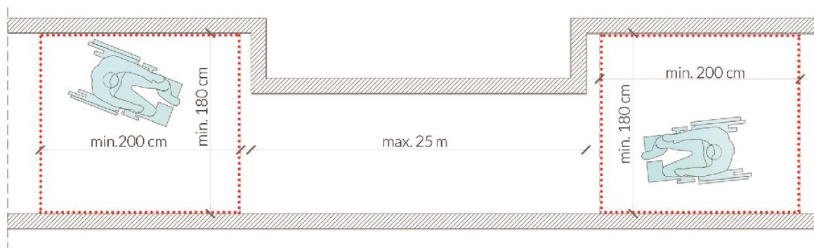
Rys. 38. Poszerzenia ciągów komunikacyjnych niezbędnych do minięcia się dwóch wózków [38]
