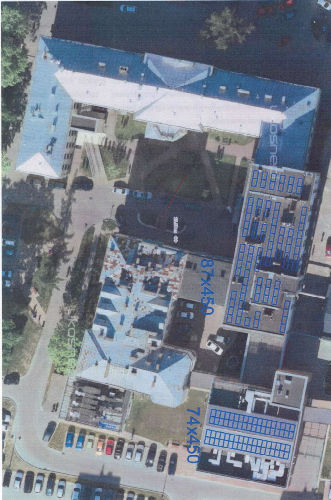
Załącznik nr 1 - Konceptyjne rozmieszczenie modułów fotowoltaicznych na dachu budynku „Pawilon 1”
