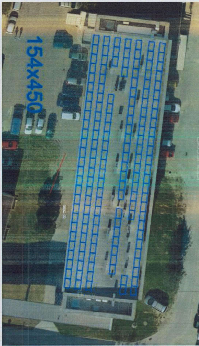
Załącznik nr 2 - Konceptyjne rozmieszczenie modułów fotowoltaicznych na dachu budynku „Pawilon 2”
