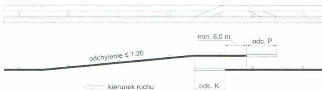
Rys. 19. Schemat zastosowania przerwy w barierze ochronnej.
