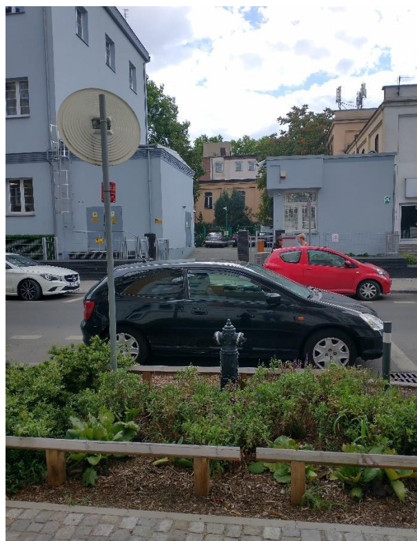
Zdj. 18 i 19 – Ulica Jackowskiego jako droga pożarowa i hydranty zewnętrzne nadziemne DN 80 - 11 i 12 m od ściany budynku.
