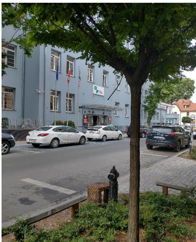
Zdj. 18 i 19 – Ulica Jackowskiego jako droga pożarowa i hydranty zewnętrzne nadziemne DN 80 - 11 i 12 m od ściany budynku.
