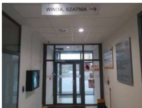
Wzorcowy wygląd tablicy kierunkowej podsufitowej (dwustronne, szerokość 1400mm, wysokość dostosowana do liczby informacji)
