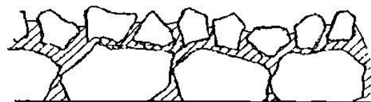
Rys. 3. Schematyczny obraz powierzchniowego utrwalenia nawierzchni typu „sandwich”
