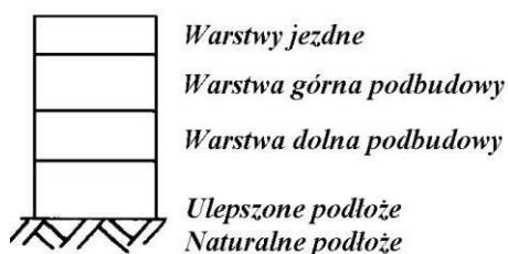
Rys. 3. Konstrukcja nawierzchni utwardzonego pobocza
