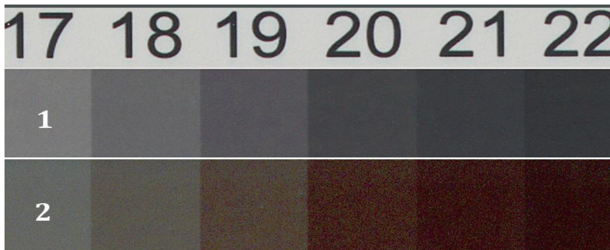
Ilustracja 22. Przykład nadmiernego szumu generowanego przez skanery podczas rejestracji. Fragment zarejestrowanego wzornika do kalibracji skanerów. 1 – skaner Epson 10000XL, 2 – skaner WideTek25.
