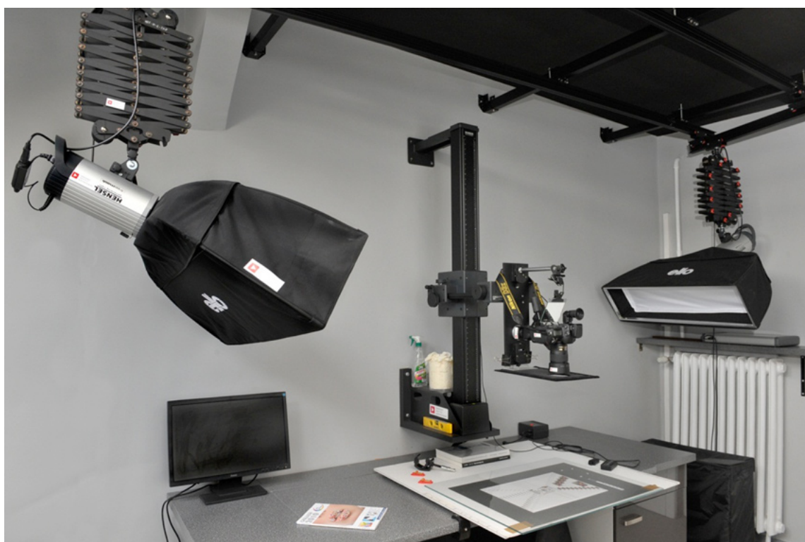
Ilustracja 3.86. Stół roboczy z pomocniczym monitorem do pracy z wykorzystaniem programu Nikon Camera Control Pro 2 z podglądem obrazu z aparatu Nikon D3x. Pracownia Dokumentacji Obrazowej Muzeum Historii Fotografii. Fot. W. Staszkiwicz
