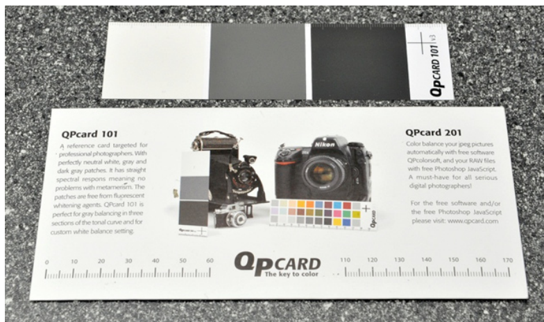
Ilustracja 3.93. Karta wzorcowa z trzema poziomami szarości o bardzo dobrych parametrach. Może służyć jako materiał do wykonania różnego rodzaju wzorców dopasowanych wielkością i układem do obiektu, który podlega digitalizacji. Fot. W. Staszkiwicz, Muzeum Historii Fotografii
