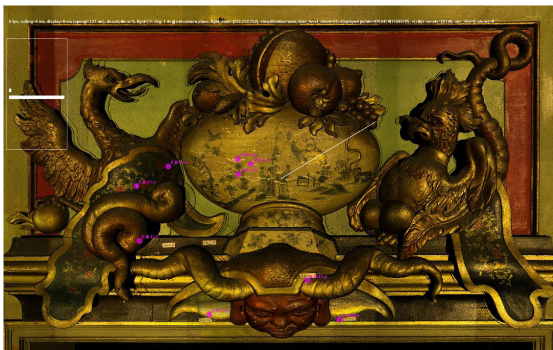
Ilustracja 3.78. Supraporta na ścianie wschodniej. Wizualizacja chmury punktów z pomiaru w stworzonym na Politechnice Warszawskiej wizualizatorze. Widoczne zaznaczone na różowo miejsca pobrania prób do badań identyfikacyjnych. Fot. R. Sitnik
