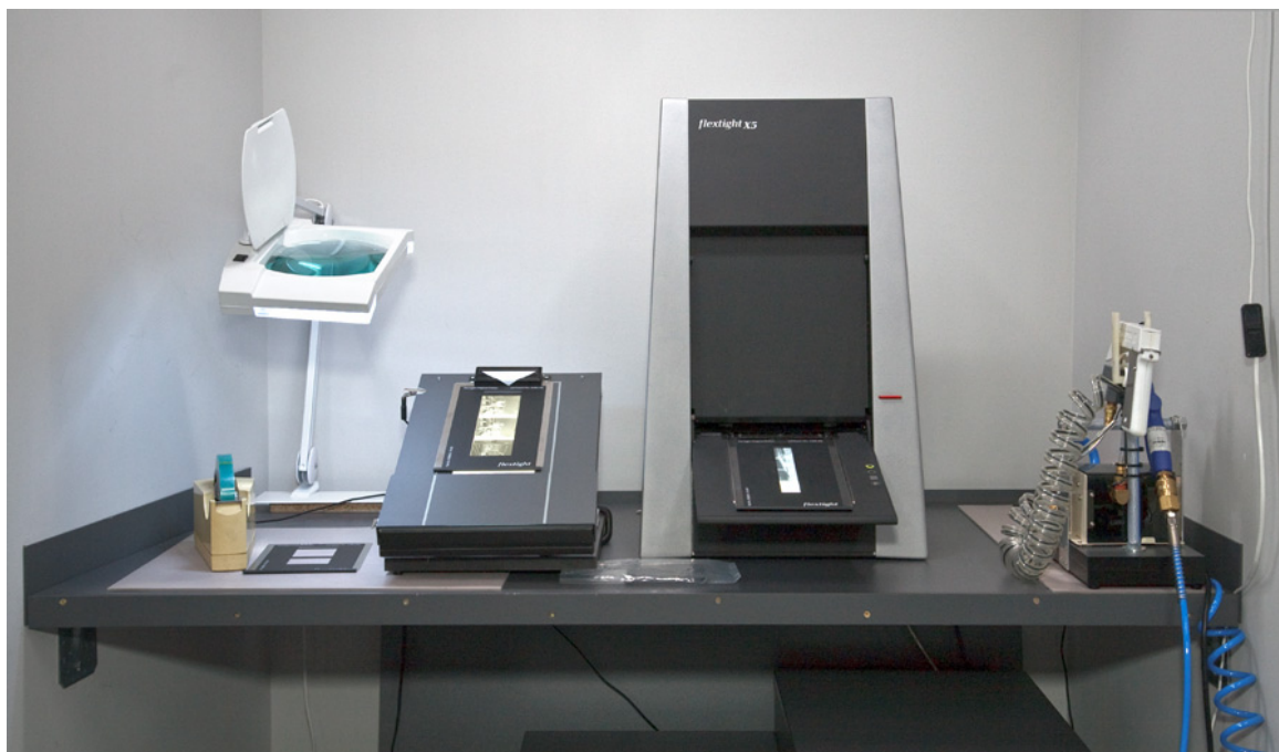
Ilustracja 2.3. Przykładowe stanowisko do skanowania. Blat roboczy mieszczący skaner oraz wyposażenie dodatkowe: matę antystatyczną, dodatkowe stanowisko ładowania „holderów”, jonizator sprężonego powietrza oraz dużą lupę kontrolną. Blat osadzony został na podkładkach antywstrząsowych, a całość przykręcona jest do ścian nośnych. Pracownia digitalizacji Muzeum Historycznego Miasta Krakowa. Fot. W. Pyzik
