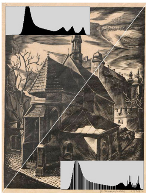
Ilustracja 4.1. Wpływ korekcji na stopień degradacji obrazu. Fragment zdjęcia po lewej (górze): obraz pierwotny; po prawej (dół): minimalnie zmieniona jasność i kontrast. Białe kreski na dolnym histogramie oznaczają utracone informacje o obrazie. Opracowanie: W. Pyzik, Muzeum Historyczne Miasta Krakowa
