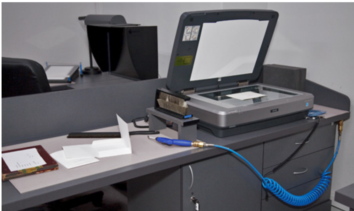
Ilustracja 2.8. Przykładowe stanowisko do digitalizacji materiałów refleksyjnych i transparentnych. Na blacie widoczne: uziemiona mata antystatyczna, dwustronna szczotka antystatyczna do negatywów oraz instalacja sprężonego powietrza. Pracownia digitalizacji Muzeum Historycznego Miasta Krakowa. Fot. W. Pyzik
