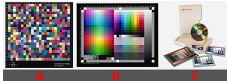
Ilustracja 3.14. Wzorniki basIColor odpowiednio: 3.14a) basIColor scan targets, dla materiałów refleksyjnych (972 pola pomiarowe); 3.14b) HutchColor HCT targets, dla materiałów refleksyjnych i transparentnych. Cztery typy indywidualnie mierzonych wzorników; 3.14c) Fuji IT8,7 targets, zestaw pięciu wzorników dla materiałów transparentnych i refleksyjnych
