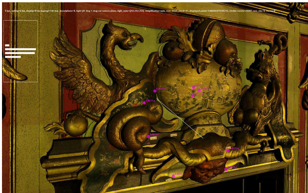
Ilustracja 3.79. Supraporta na ścianie wschodniej. Wizualizacja chmury punktów z pomiaru. Widoczne zaznaczone na różowo miejsca pobrania prób do badań identyfikacyjnych. Fot. R. Sitnik
