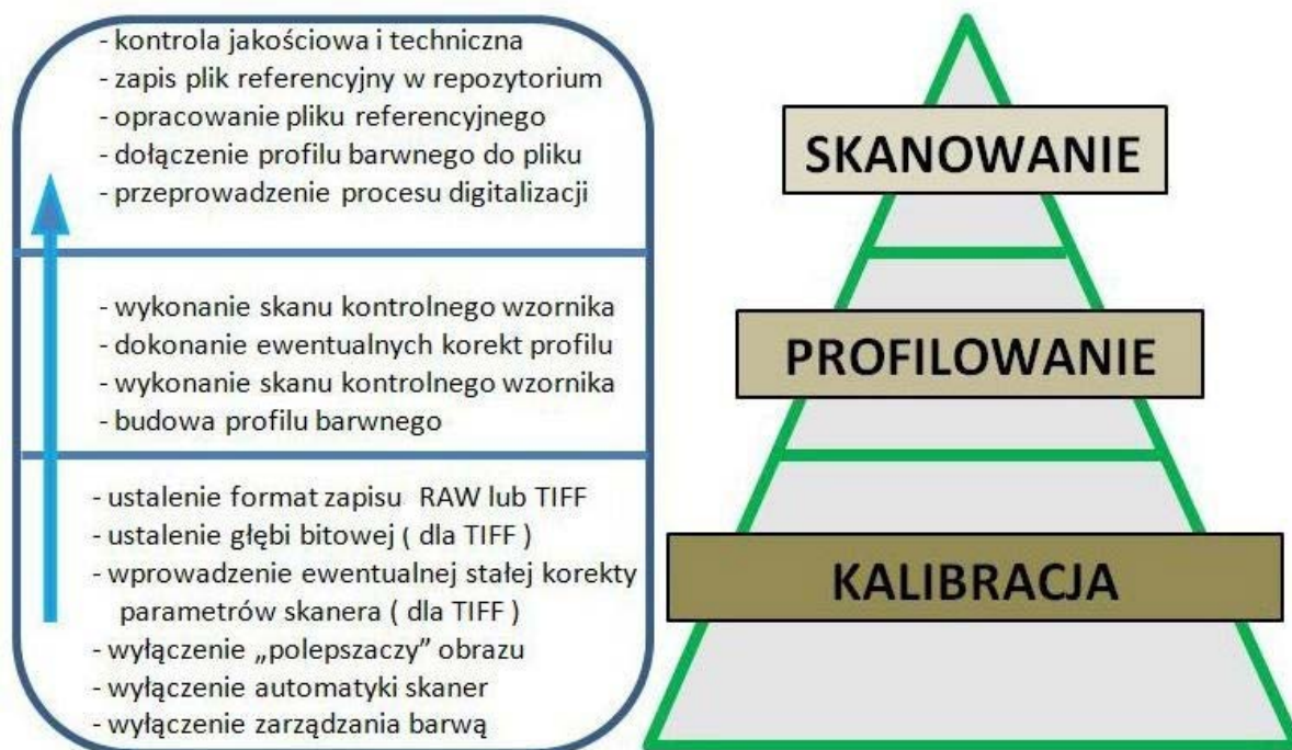
Ilustracja 3.19. Schemat przedstawiający hierarchiczność procedury kalibracji, profilowania i skanowania. Opracowanie: W. Pyzik, Muzeum Historyczne Miasta Krakowa
