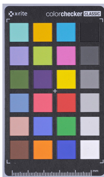
Ilustracja 3.92. Najczęściej używana tablica wzorcowa ColorChecker z 24 polami. Fot. W. Staszkiwicz, Muzeum Historii Fotografii
