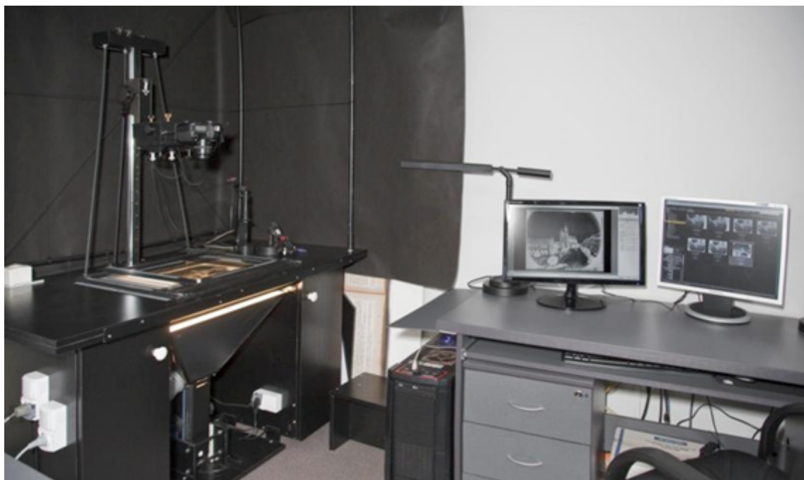
Ilustracja 3.61. Stanowisko do reprodukcji klisz szklanych, Pracownia Digitalizacji, Muzeum Historyczne Miasta Krakowa. Fot. W. Pyzik
