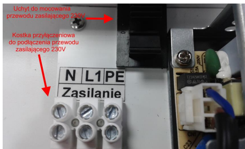
Fot.5. – Kostka przyłączeniowa zasilania 230V
