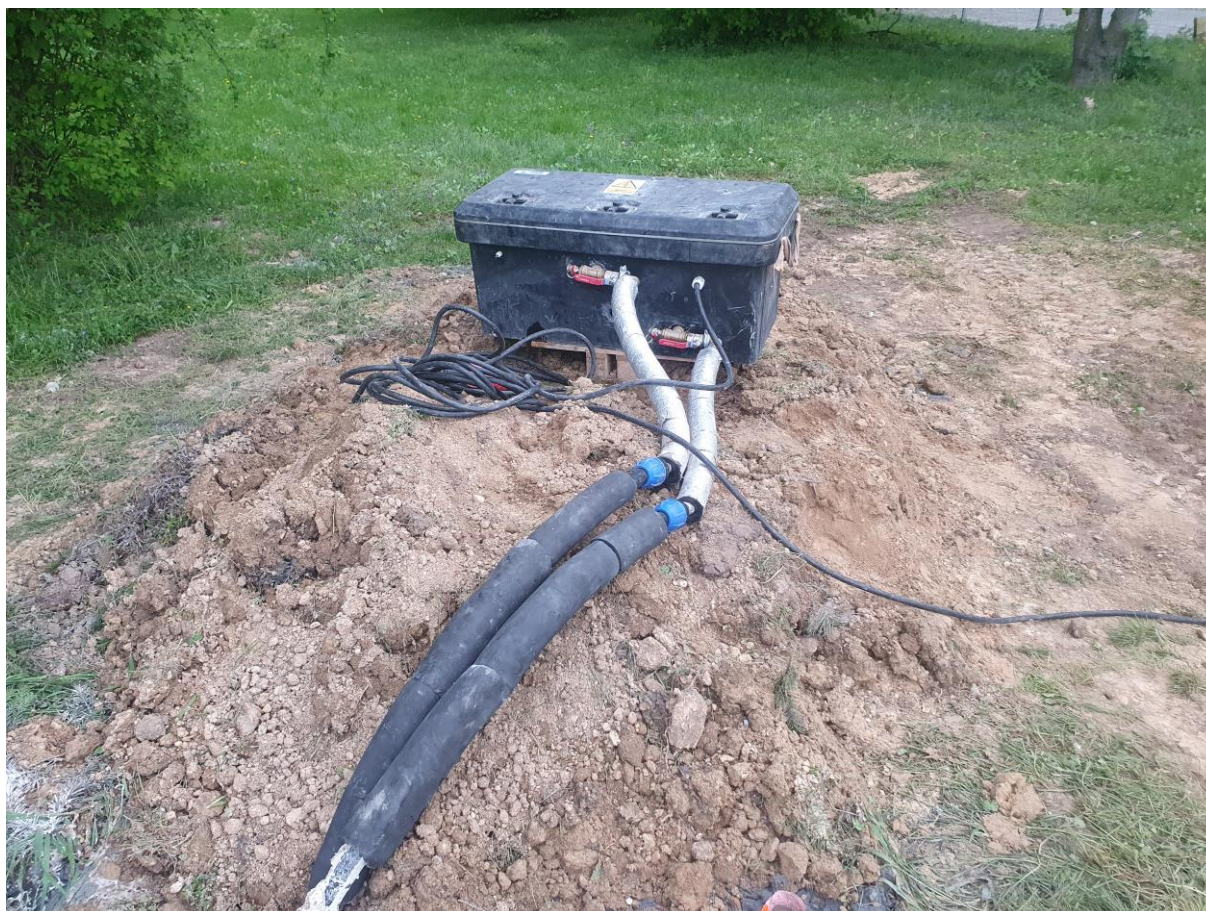
Rysunek 2 Urządzenie TRT podczas badań na otworze testowym
