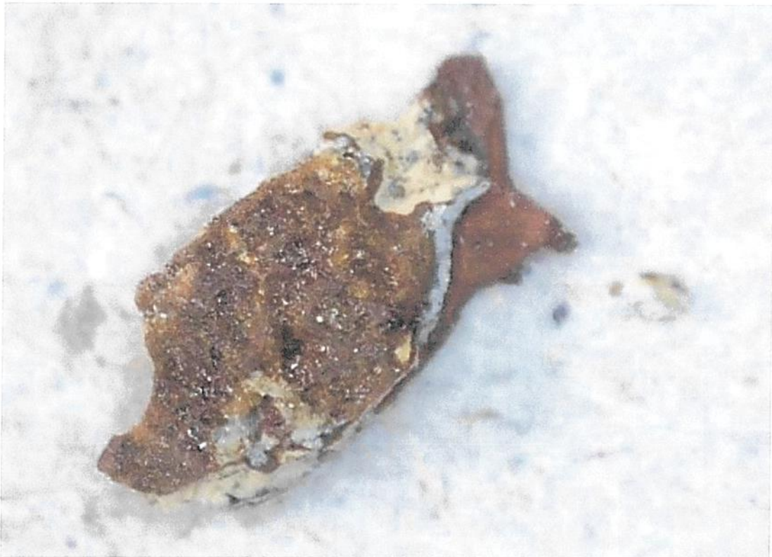
Fot 124 mikroskopowa – malatura na stolarce okiennej
