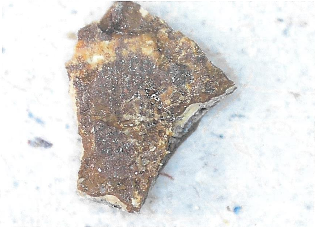
Fot 123 mikroskopowa – malatura na stolarce okiennej
