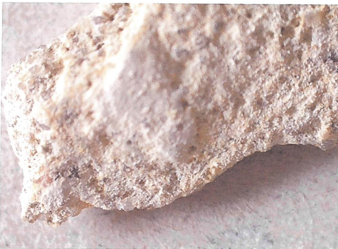
Fot 122 fotografia mikroskopowa – kremowy kolor oryginalnej malatury na ścianie latarni
