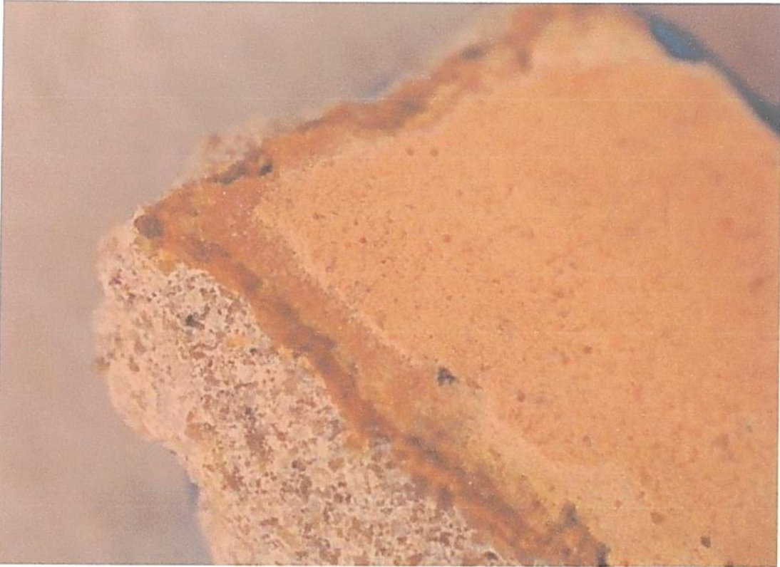
Fot 125 mikroskopowa – malatura na gzymsie latarni
