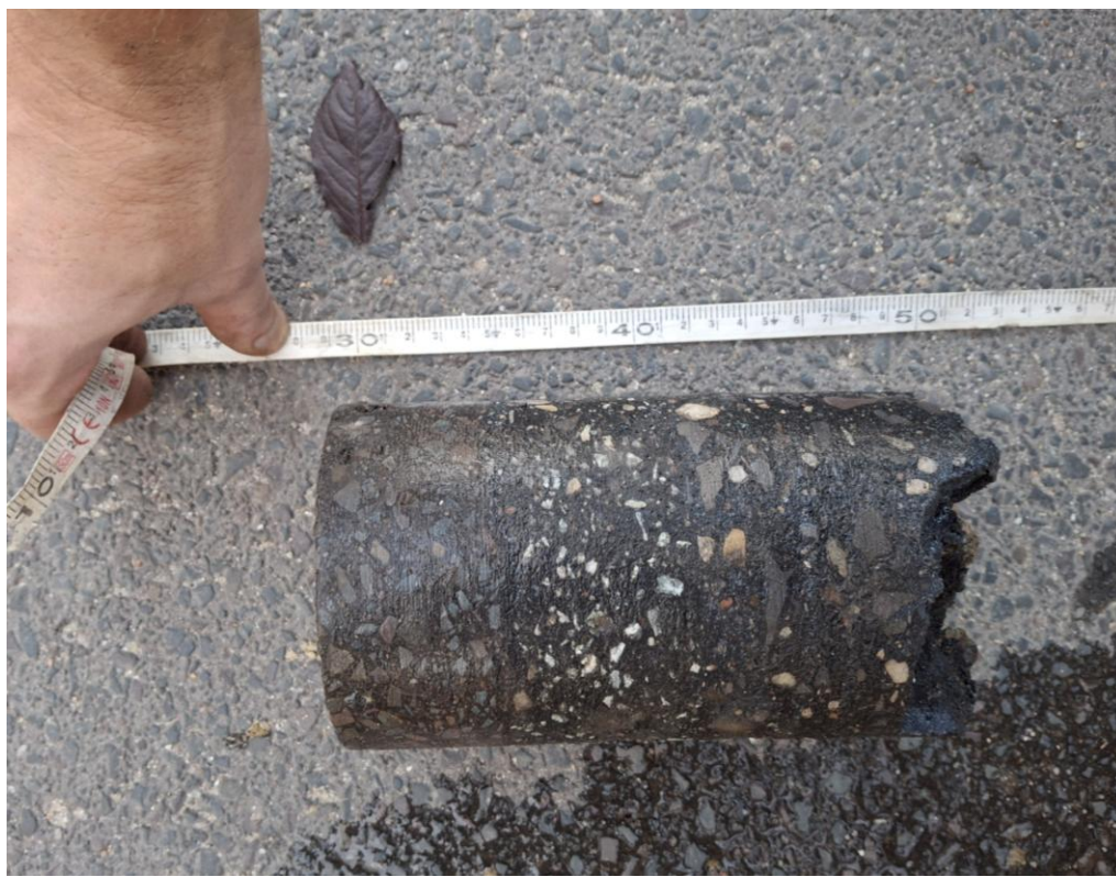
Fot. 2. Fotografia z całością uzyskanego rdzenia wiertniczego w punkcie badawczym nr 8 - patrząc od po lewej widoczne dwie kolejne warstwy .
