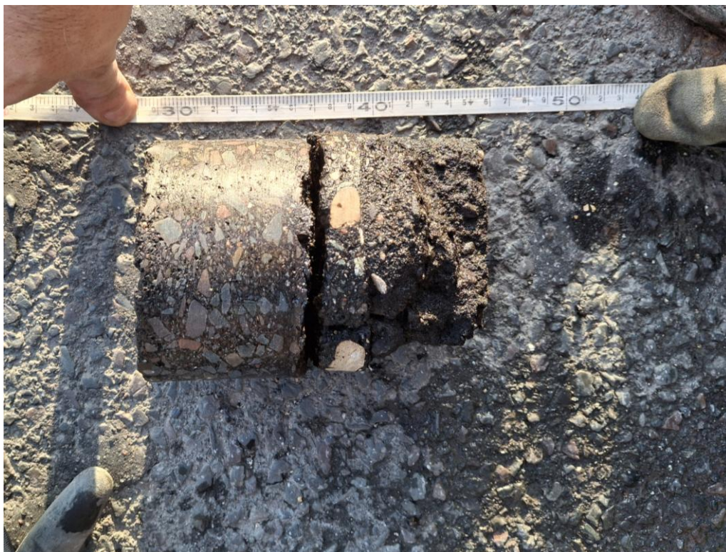
Fot. 1. Fotografia z całością uzyskanego rdzenia wiertniczego w punkcie badawczym nr 7 - patrząc od po lewej widoczne dwie kolejne warstwy .
