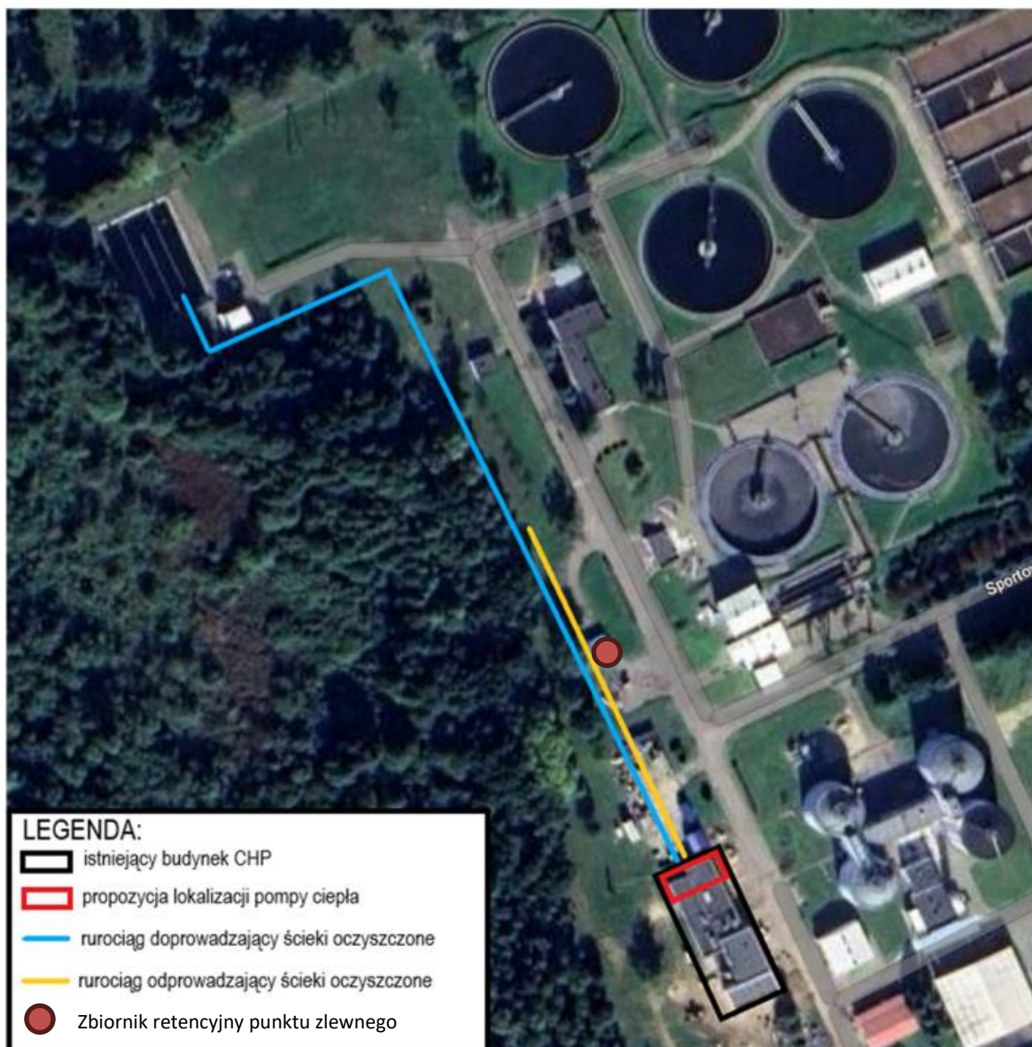
Rysunek 2 Koncepcja lokalizacji pompy ciepła wraz z zasilaniem i zrzutem
