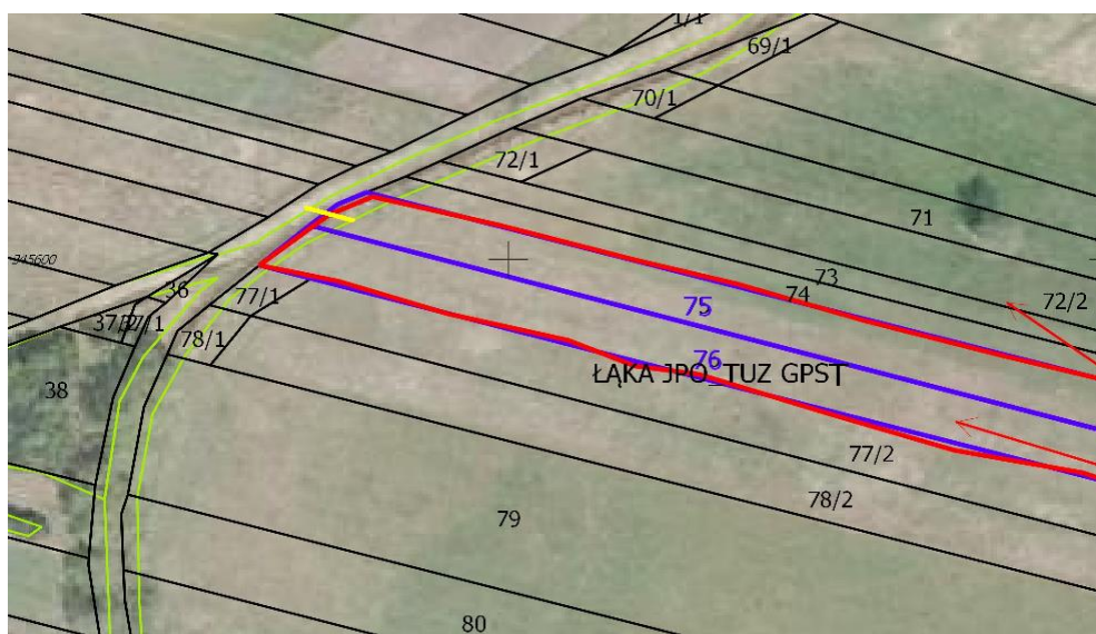
Rys. 45. Rozbieżność wektora pomiaru działki rolnej i pól zagospodarowania jest mniejsza niż dopuszczalna wartość odchyłki.
