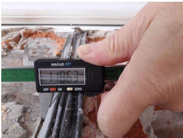
Ryc.17 Pole 2 – pomiar stopki dolnej belki stalowej stropu
