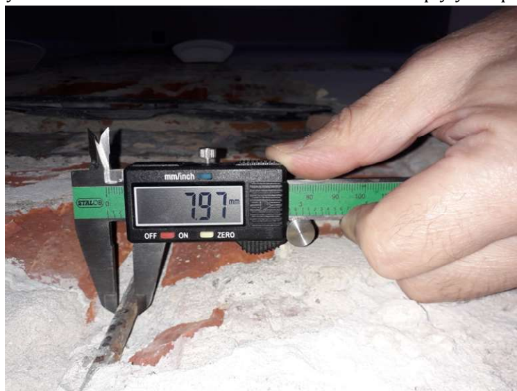
Ryc.16 Pole 2 – pomiar średnicy pręta zbrojeniowego
