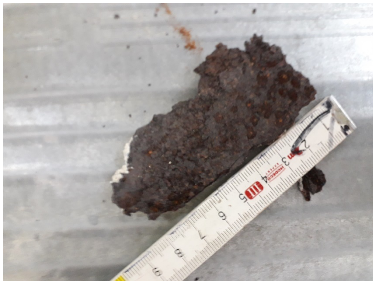
Ryc.20 Pole 3 – warstwa korozji stali odspojona za stopki dolnej belki stropu
