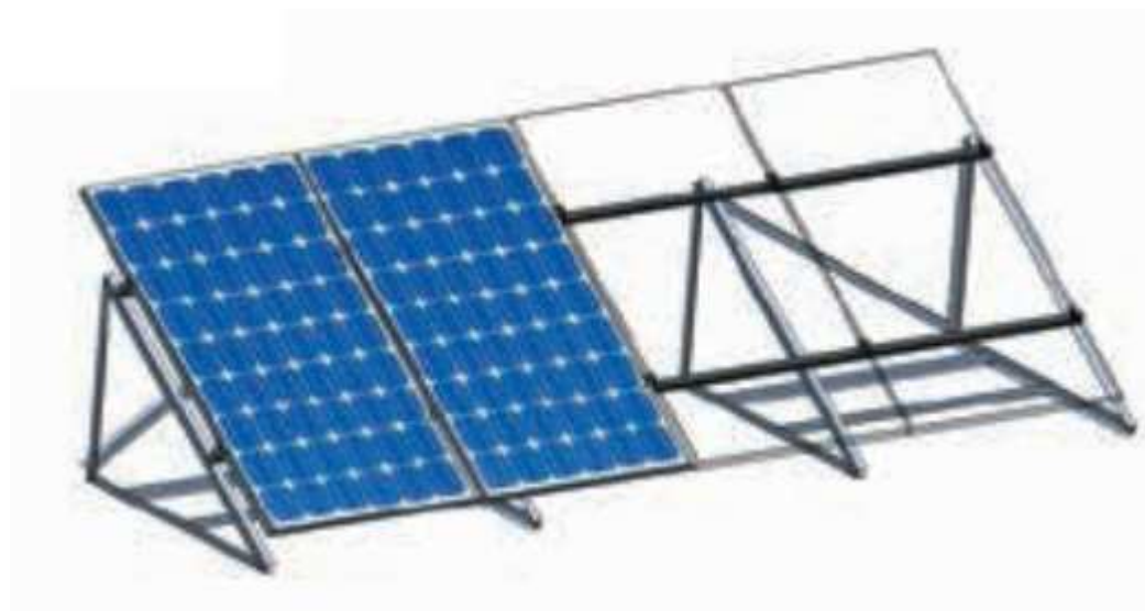
Rys.1. Montaż kolejnych paneli PV.
