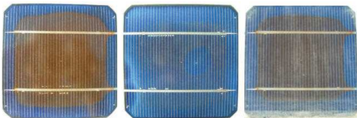
Fot. Przykłady przebarwień modułów PV przy 18 letnim okresie użytkowania ( http://www.instsani.pl/510/problemy-w-pracy-paneli-pv )
