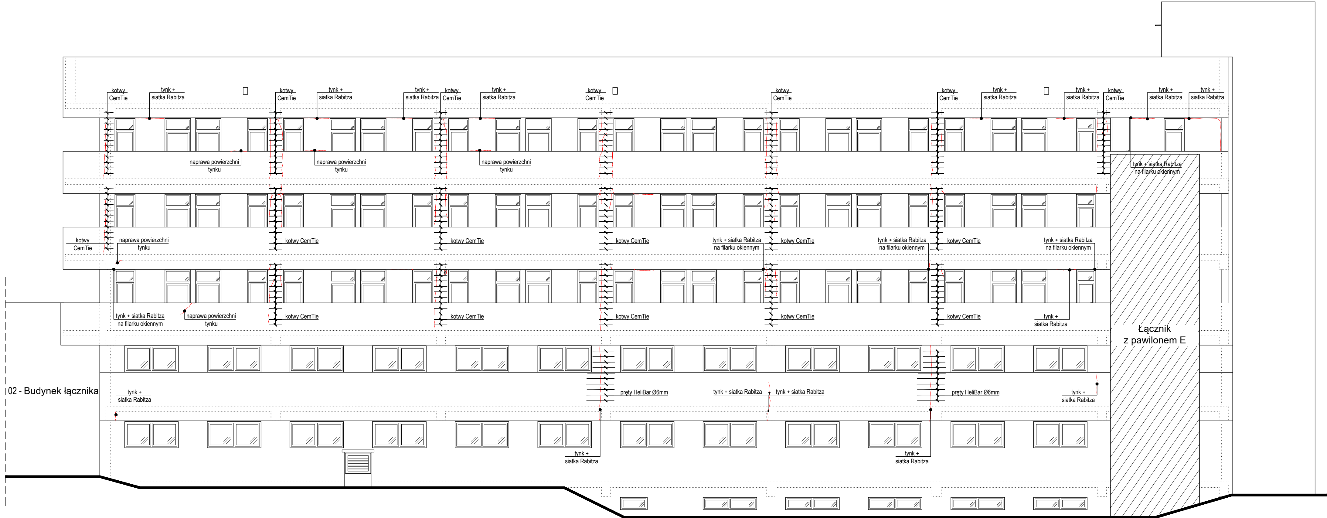
System HELIFIX Naprawa odspojenia bloczków gazobetonowych od konstrukcji żelbetowej kotwami CemTie skala 1:20
