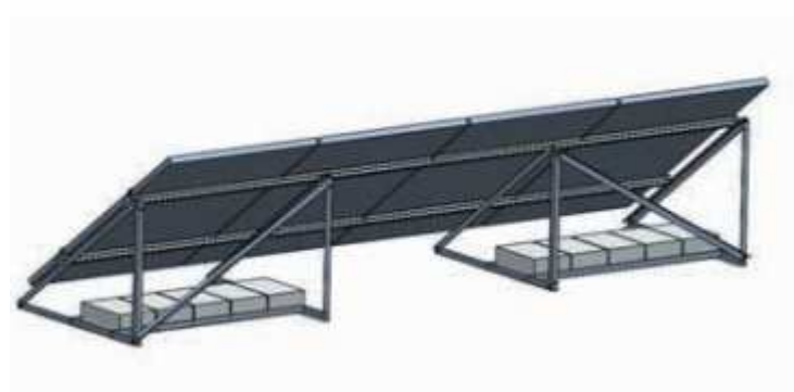
Rys.2. Osadzenie balastu (bloczki obciążeniowe betonowe).
