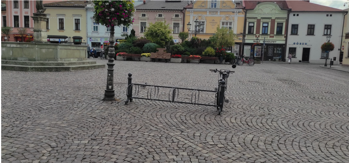
Rys. 32 Nieprawidłowy stojak rowerowy „wyrwikółko” na Rynku w Skoczowie.
