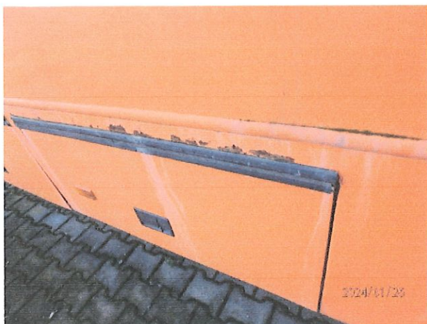
Fot. 9. Korozja nad drzwiami bagażnika.
