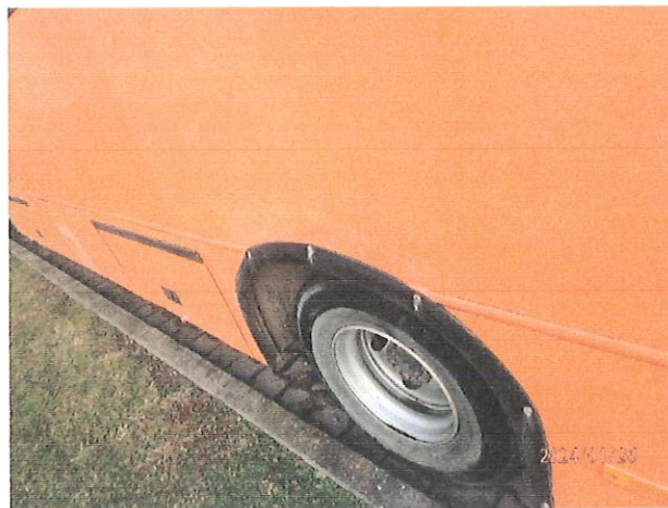
Fot. 10. Korozja na nadkolu.
