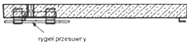
Rys. 7. Pokrywa z rygłem przesuwным
