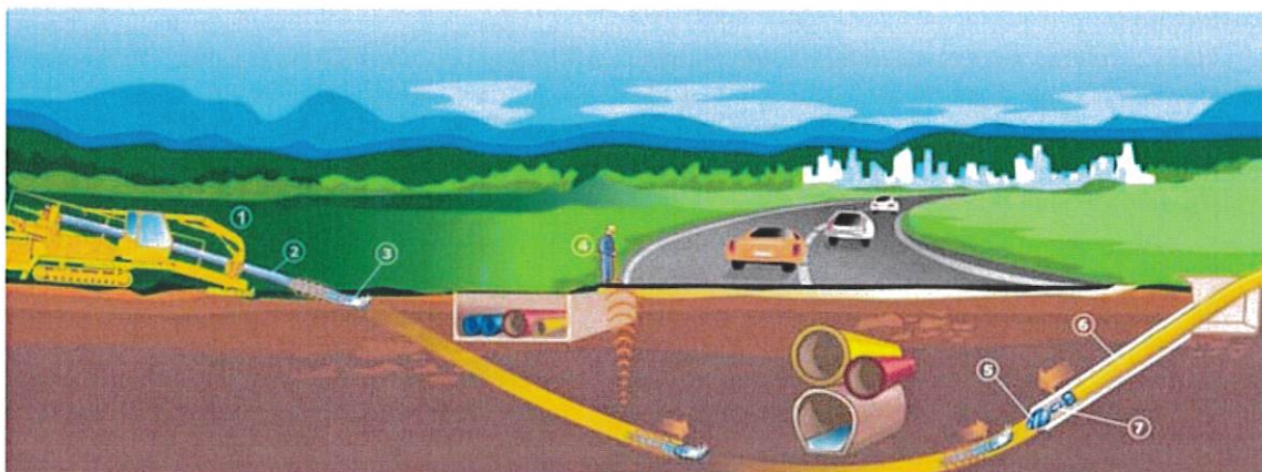
Rys. 29. Wykonywanie otworów pod kanalizację kablową metodą przewiertu
