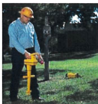
Rys. 40. Lokalizowanie i pomiar głębokości znaczników elektromagnetycznych
