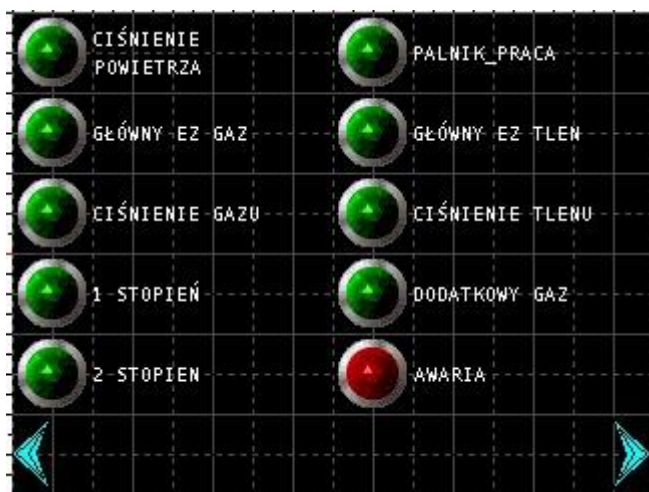
Rys.2 panel diagnostyczny z kontrolkami
