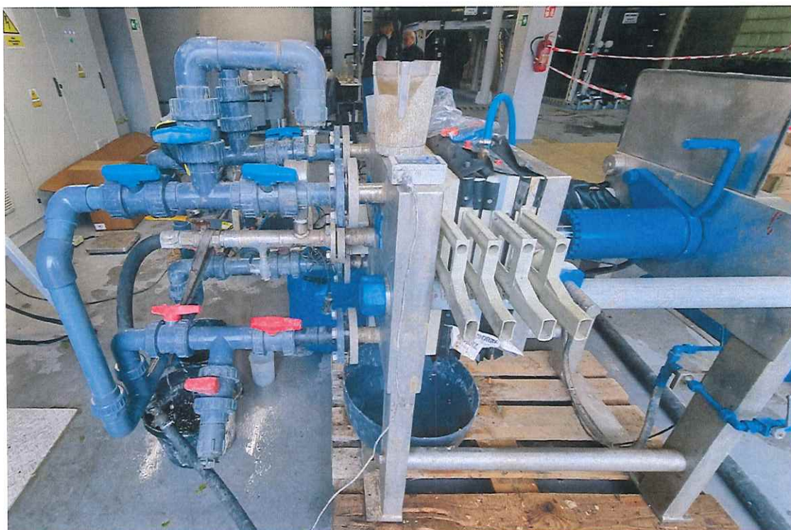
Fotografia Testowej Prasy Filtracyjnej 470x470, 2 komory głowica z orurowaniem, system hydrauliczny.
