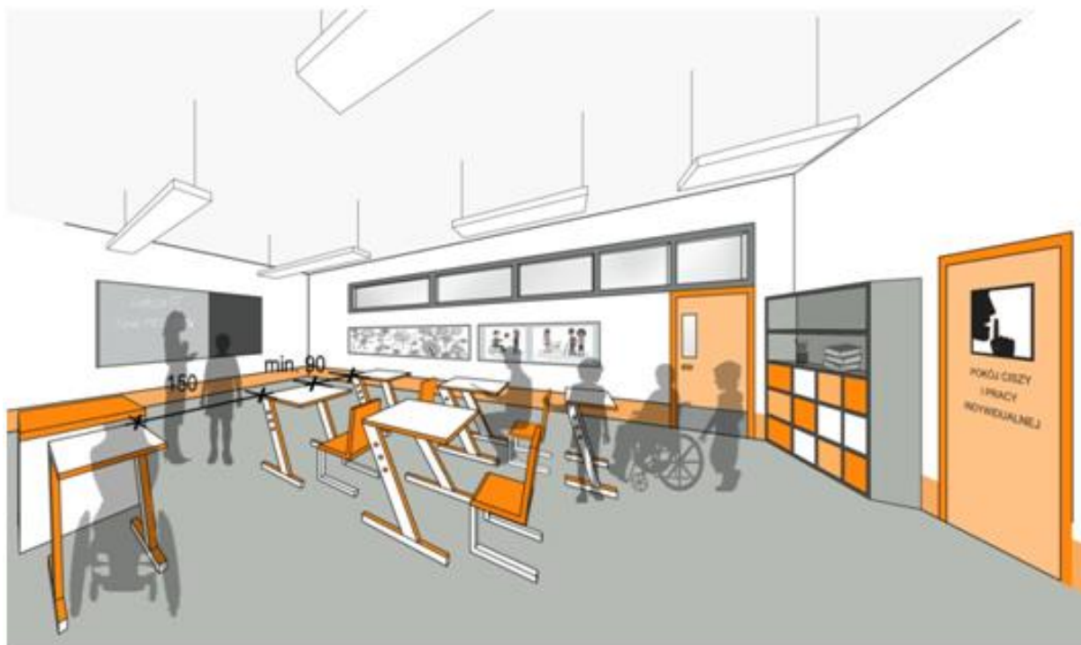
Rysunek 55. Przykład kształtowania sal lekcyjnych zgodnie z określonymi zaleceniami [rys.: N. Ratajczak-Szponik, Dostosowanie polskich szkół z początku XXI wieku do potrzeb dzieci z niepełnosprawnościami..., op.cit., s. 297].
