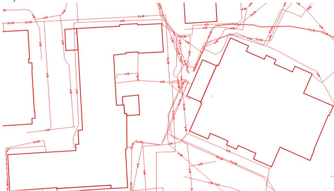
Rys. 7. Uzbrojenie terenu w zakresie sieci elektroenergetycznej między budynkami Gmachu Fizyki i Wydziału Elektrycznego.
