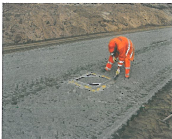
Wymiatanie z tacki pomiarowej spoiwa znajdującego się poza szablonem
