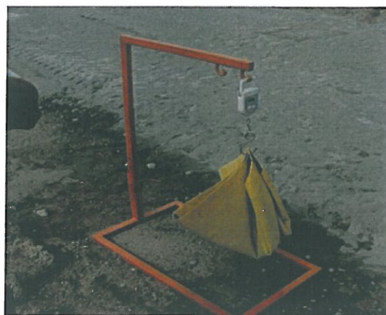
Ważenie tacki pomiarowej ze spoiwem
