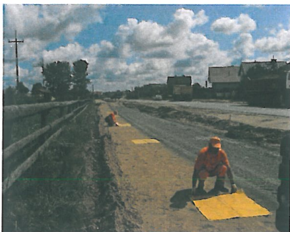
Rozmieszczenie tacek pomiarowych
