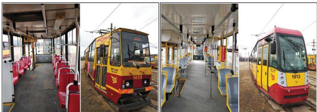
Rysunek 3 - Wagony typu 805 Na przed i po modernizacji
